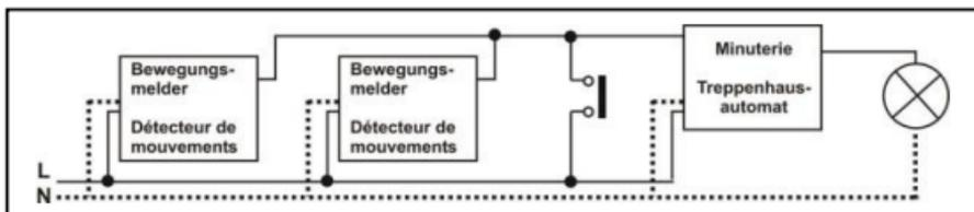
Branchement en parallèle de plusieurs détecteurs de mouvement (max. 3-4) avec interrupteur pour éclairage permanent
