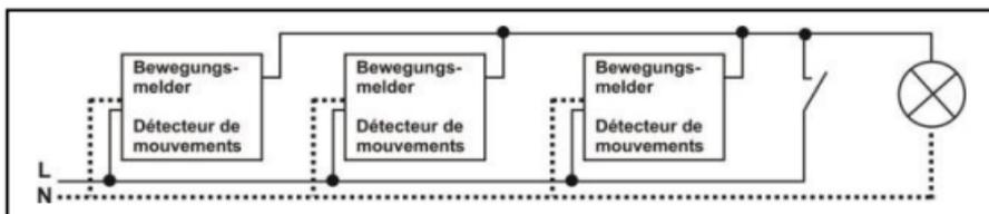
Lors de tensions de crête ou d'interférences dues au branchement en parallèle de lampes à économie d'énergie ou de relais, branchez un condensateur de compensation (RC) (entre le neutre et le retour). Il est également possible de brancher une varistance (U) entre la phase et le neutre. **RC**= Condensateur de protection **U**= Varistance
