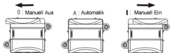
Wie bei einem normalen Handschalter kann das Licht dauernd EIN oder AUS geschaltet werden. In der Mittelstellung schaltet das Licht automatisch.
