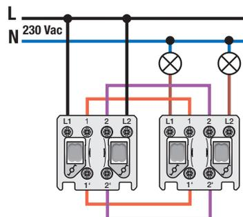
Mécanisme pour un interrupteur va-et-vient double, avec fixation par vis. Les interrupteurs va-et-vient sont utilisés pour commander une même lampe à partir de deux endroits différents. Un set de finition et une plaque de recouvrement d'une couleur au choix doivent être commandés séparément.
