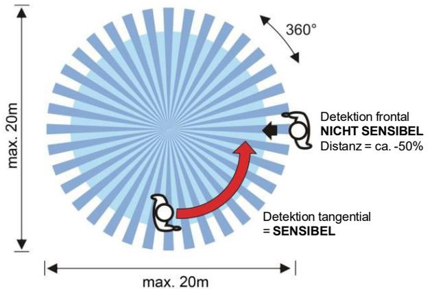
Die Reichweite ist abhängig von Montageort und Gehrichtung. Da der Bewegungsmelder auf den Temperaturunterschied zwischen Wärmequelle und Umgebungstemperatur reagiert, kann die Reichweite je nach Situation und Montageort variieren.
